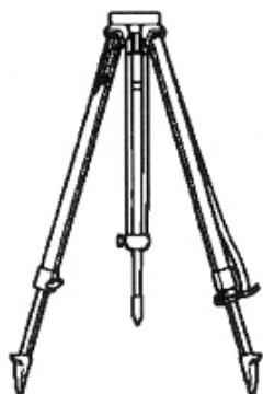
Trípode de aluminio de patas ajustables Tipo E Cabeza plana 5/8" x 11 hilos con patas ajustables
